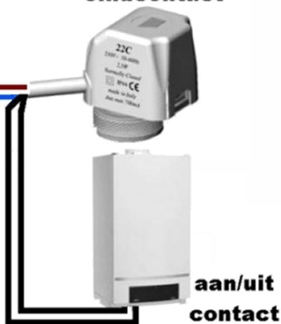
aansluiten van stelmotor met eindcontact
